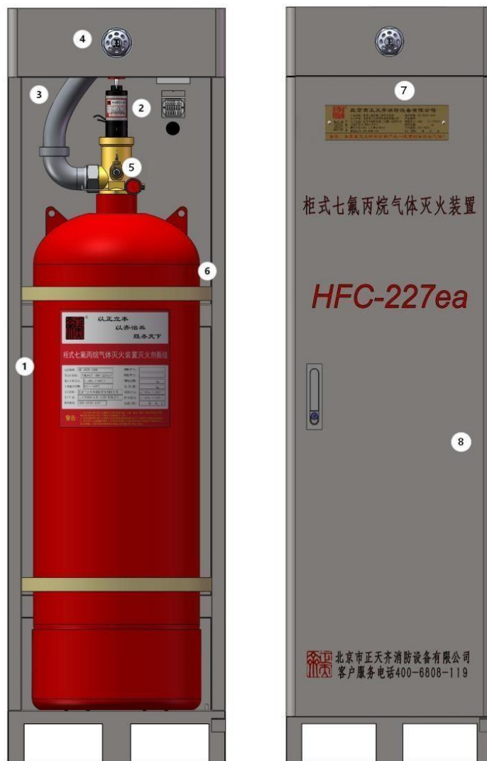
图 2 单瓶组柜式七氟丙烷灭火装置组成
