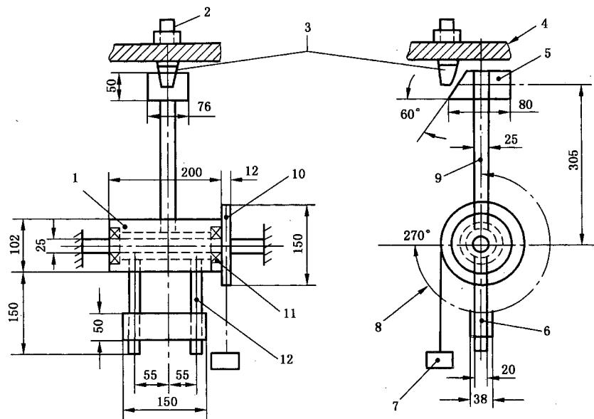
图 10 喷嘴耐油击试验装置
